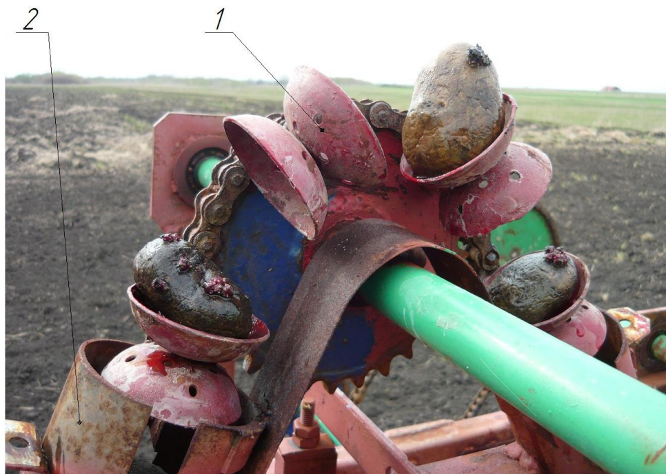
Рисунок 5.4 – Технологический переход клубня с ложечки, захвативший клубень, на тыльную сторону второй ложечки: 1 – ложечка транспортёра; 2 – защитный кожух.
