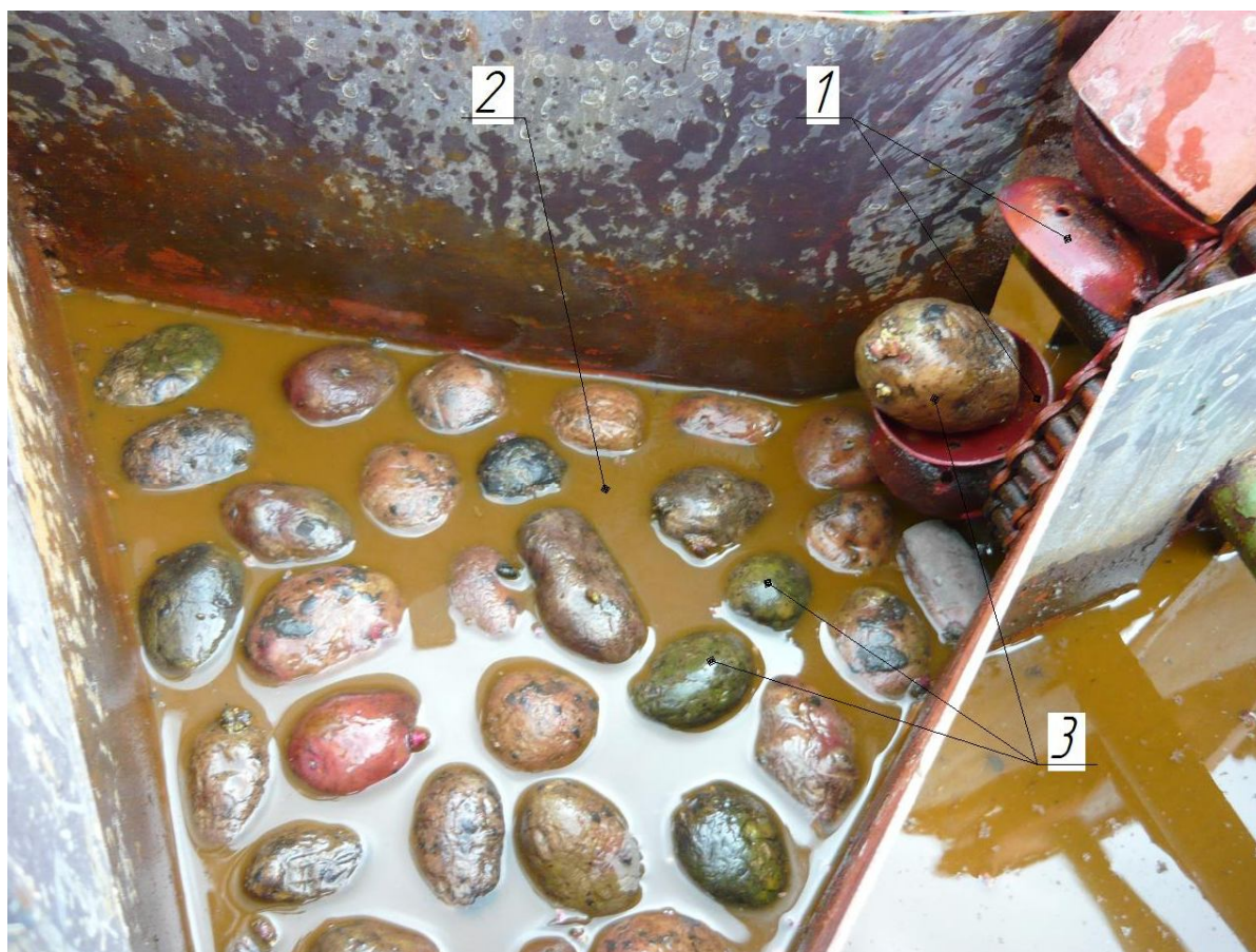
Рисунок 5.3 – Технологический процесс захвата клубней ложечками транспортёра в ковше-питателе: 1 – ложечки транспортёра; 2 – водно-солевой раствор протравливающей жидкости; 3 – пророщенные клубни картофеля (клубни картофеля в 1 слой)
