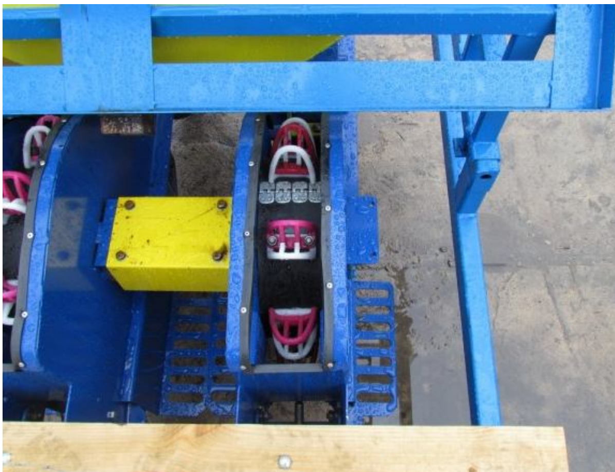
Рисунок 1.8 – Ложечно-транспортёрный высаживающий аппарат картофелесажалки СПК-6
