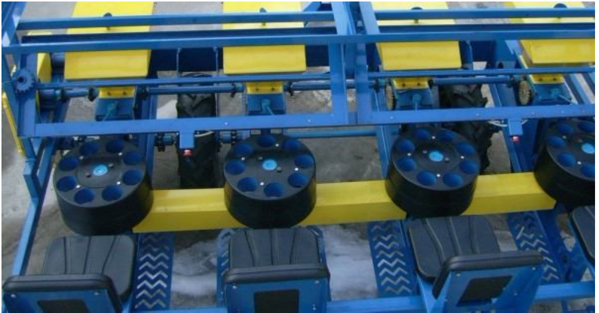
Рисунок 1.9 – Револьверный высаживающий аппарат картофелесажалки СКН
