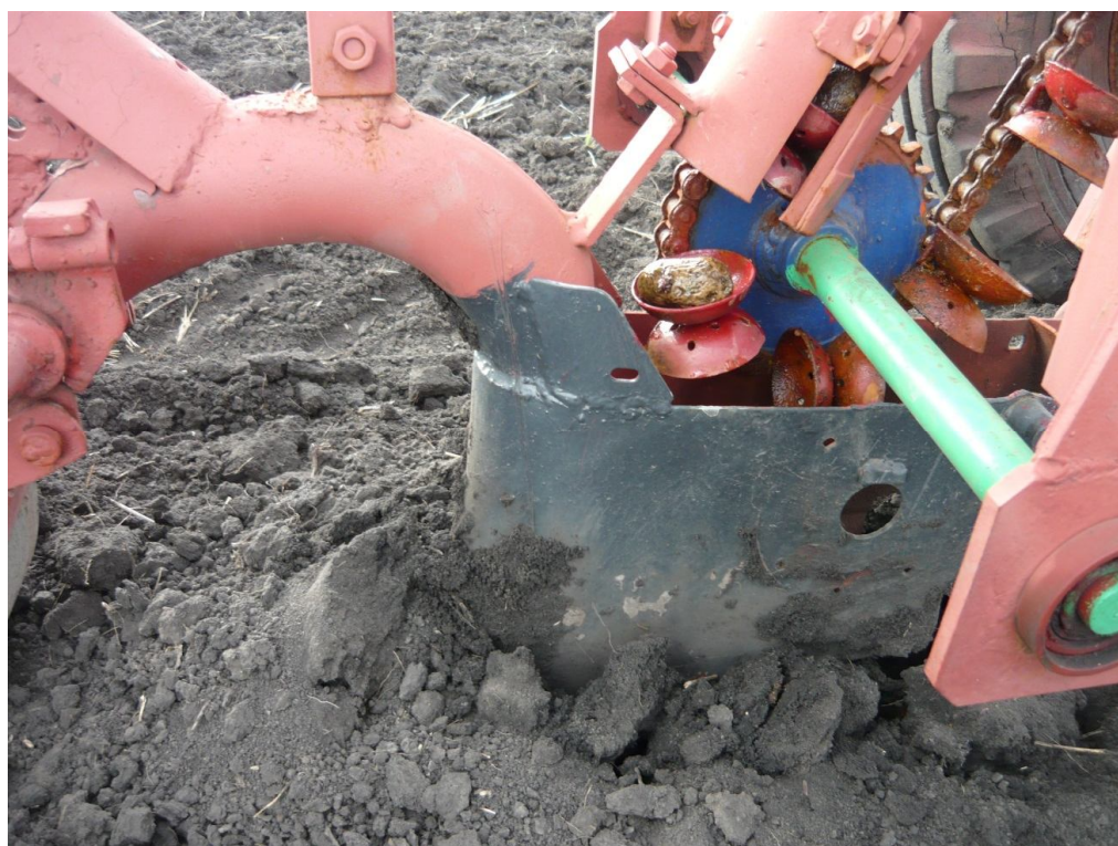
Рисунок 5.5 – Технологический процесс сброса клубней ложечками транспортёра на дно борозды
